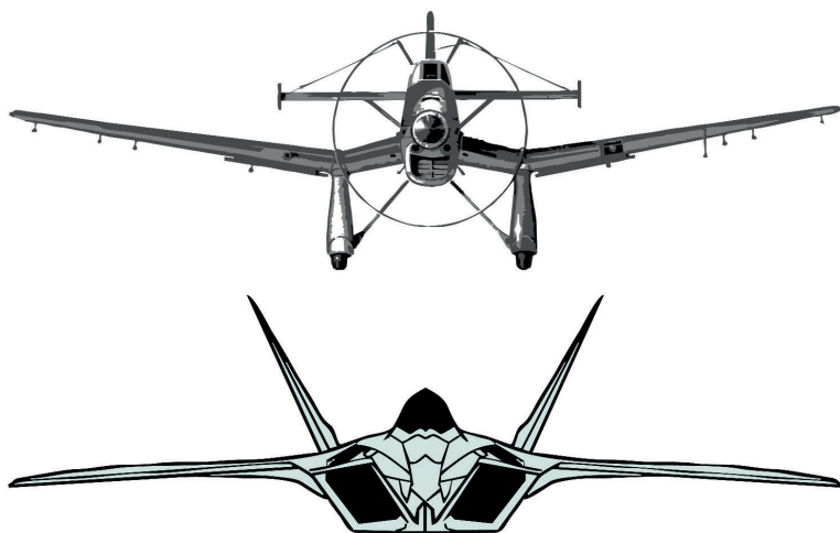
2. ábra. Stabil (fent) és instabil szárnyelrendezés (alul)
