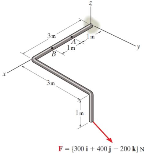
$$\underline{M}_0 = \underline{r}_{F0} \times \underline{F} = \begin{bmatrix} 3 \\ 3 \\ -1 \end{bmatrix} \times \begin{bmatrix} 300 \\ 400 \\ -200 \end{bmatrix} = \begin{bmatrix} -200 \\ 300 \\ 300 \end{bmatrix} \text{ Nm}$$
