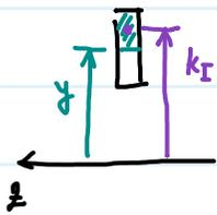
$$S_I(y) = A_I \cdot k_I \quad A_I = 0,02(0,15 - y) \quad k_I = y + \frac{1}{2}(0,15 - y)$$
