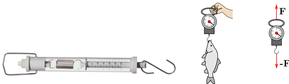
1.18. ábra. Rugós erőmérő [A23, A24]
