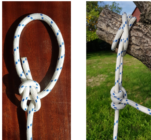
7.18. ábra. Különbféle csomók: palstek, szorító nyolcas és Magnus-csomó [A64]
