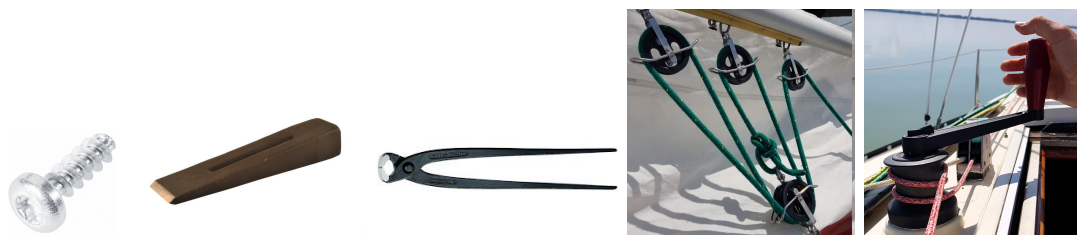
1.5. ábra. Néhány egyszerű gép: csavar, ék, fogó (két emelő), csiga, hengerkerék [A3]
