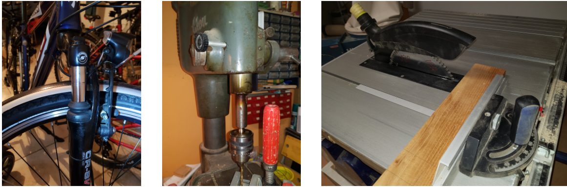
1.64. ábra. Csúszkával modellezhető kapcsolatok: kerékpár teleszkópos első vilája, oszlopos fűrőgép, gérvágó készülék megvezetése körfűrészben [A50]
