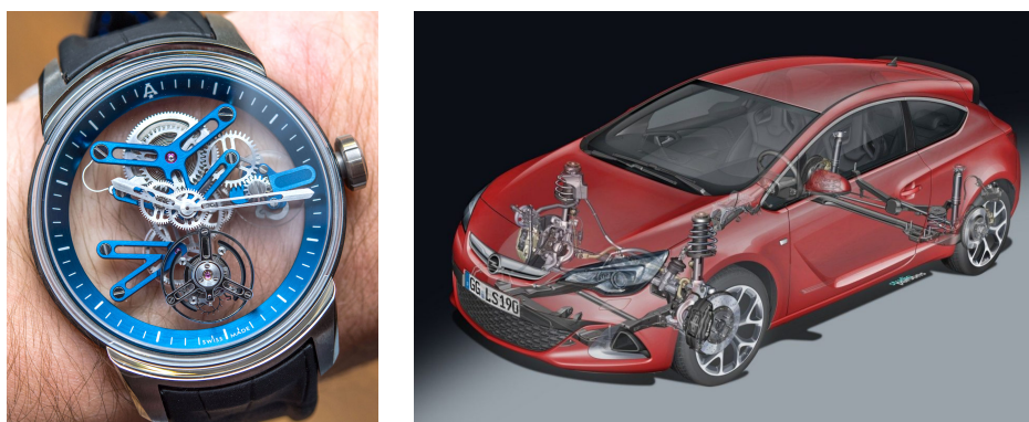
1.10. ábra. Bal oldalon: mechanikus karóra. Az óra alsó részén látszik a rezgő mozgást végző ún. billegő, a hozzá kapcsolt rugóval [A10]. Jobbra: gépkocsi futóműve [A11]
