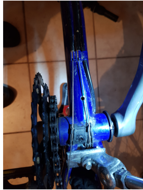
1.59. ábra. Balra: a Lakihegyi adótorony [A46]. Jobbra: kerékpár váltójának bowdeni [A47]
