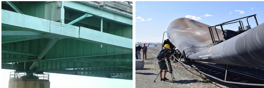
1.8. ábra. Egy törött főtartójú híd a Mississippi folyó felett [A6], és egy külső nyomástól összeroppant tartály [A7]
