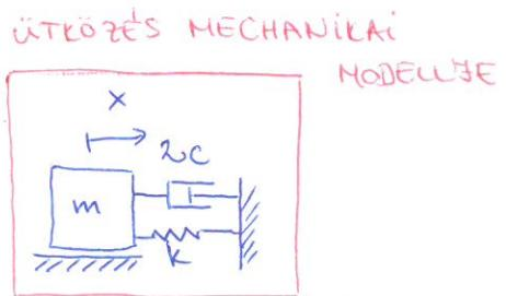
Adatok:  $m = 5 \cdot 10^4 \text{ kg}$      $v_0 = 1 \text{ m/s}$
