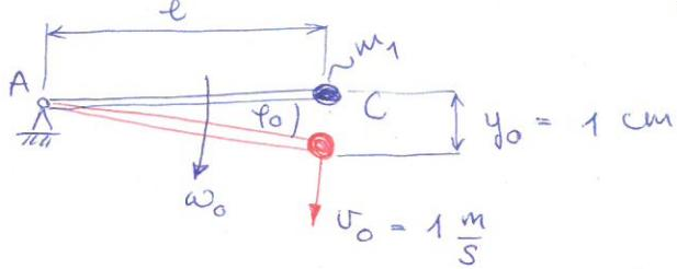
$$\varphi_0 \approx \frac{y_0}{l} = 0,01 \text{ rad} \quad \text{④ a felvett } \varphi \text{ irány miatt}$$
