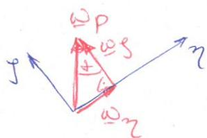
$$\begin{matrix} \omega_p \\ (x, y, z) \end{matrix} = \begin{bmatrix} 0 \\ \omega_p \sin \alpha \\ \omega_p \cos \alpha \end{bmatrix}$$
