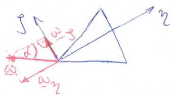
$$\begin{matrix} \omega \\ (x, y, z) \end{matrix} = \begin{bmatrix} 0 \\ -\omega \cos \alpha \\ \omega \sin \alpha \end{bmatrix}$$
