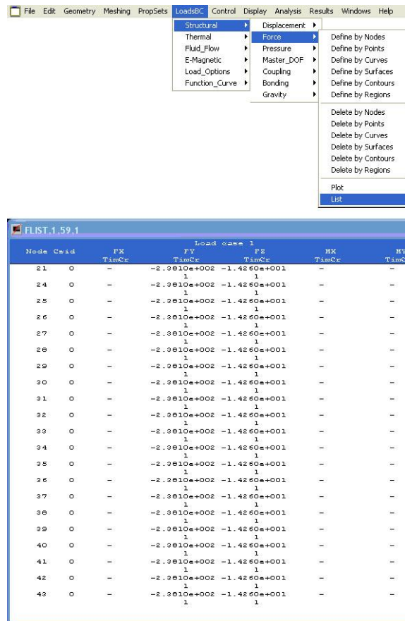
8.22. ábra. A létrehozott terhelések listázása
