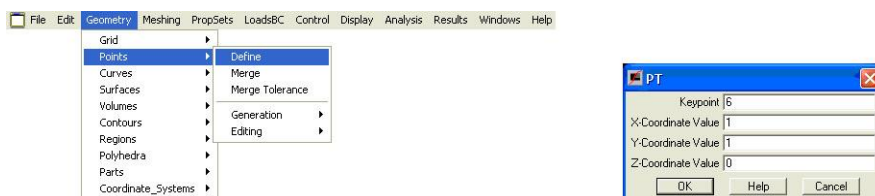
8.11. ábra. Pont elhelyezése végeselem programban
