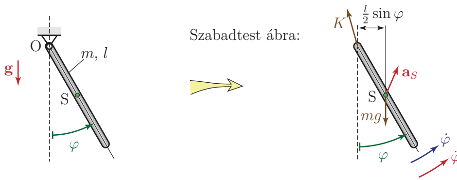
2.10. ábra. Egyszerű fizikai inga és szabadtest ábrája.
