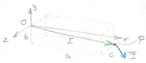
$r_{OP} = \begin{bmatrix} 5 \\ -3 \\ -4 \end{bmatrix} \text{ [m]}$      $F_P = \begin{bmatrix} 6 \\ -2 \\ 8 \end{bmatrix} \text{ [N]}$
