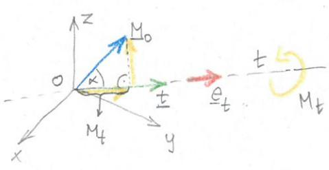
$M_0 = \begin{bmatrix} 21 \\ -7 \\ 14 \end{bmatrix} \text{ [Nm]}$ ,     $\underline{t} = \begin{bmatrix} 2 \\ 3 \\ 6 \end{bmatrix} \text{ [-]}$
