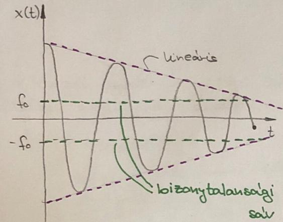
$f_0$  - statikus kitérés,  $\mu N$  állandó nagyságú erő hatására a rendszer  $f_0$  kitérést produkálha
