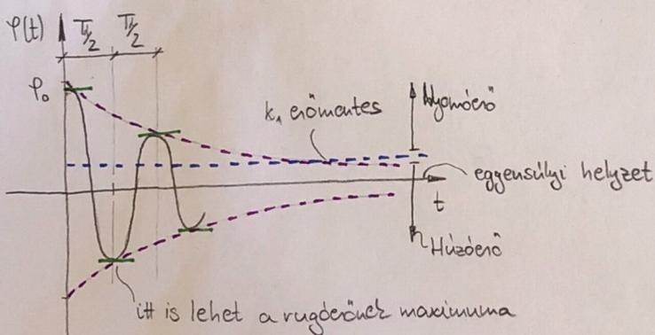
A rugóban lévő statikus deformáció miatt a maximális rugóerő nem biztos, hogy a maximális kitértéskor előfordul!
