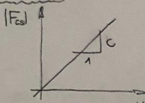
c - csillapítási tényező  $\left[\frac{\text{Ns}}{\text{m}}\right]$
