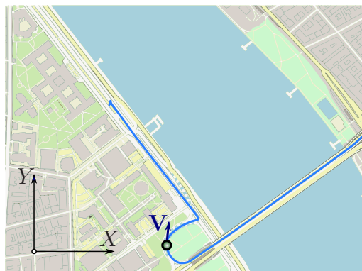
1.1. ábra. Anyagi pont modellel írható le egy V sebességgel haladó gépkocsi mozgása az utakon.
