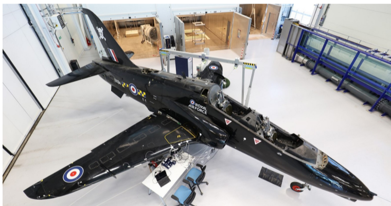
1. ábra. Hawk T1A repülőgép szárnyának modális vizsgálata
