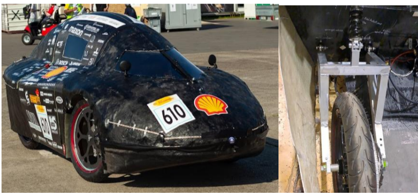
1-2. ábra: Az Urban Concept, avagy „Luna” (balra), és a jelenleg alkalmazott lengőkar (jobbra)
