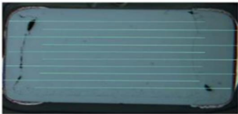
1. ábra Mikrorepedések egy nyúlásérzékeny komponensben
