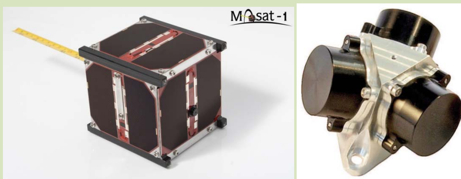
3. ábra: A MASAT1 műhold és egy kisméretű giroszkóp ( www.astrofein.com ).
