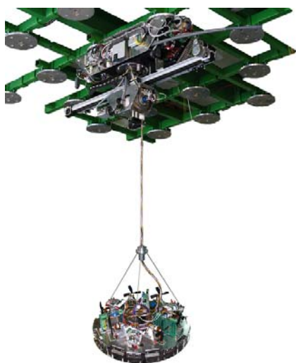
2. ábra: Az ACROBOTER robot és a digitális szabályozás vizsgálatára épített kísérleti eszköz.
