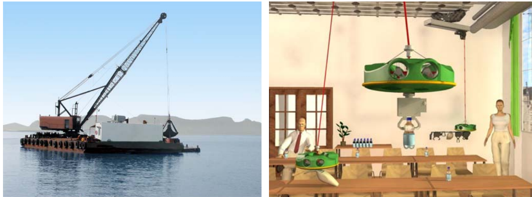
2. ábra: veszélyes lengésekre hajlamos úszódaru (balra), az ACROBOTER önállóan működő háztartási szervizrobot és környezetének számítógépes modellje (jobbra)
