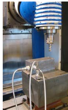
5. ábra: A rendszer dinamikai tulajdonságainak mérése valamint a mérési összeállítás (fotók). Az elméleti és a mérési eredmények összehasonlítása.
